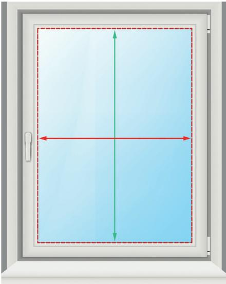
Die Befestigung auf der schmalen Leiste direkt vor dem Fensterglas - auch Glasleiste oder Fensterfalz genannt ist die beliebteste Befestigungsvariante.
